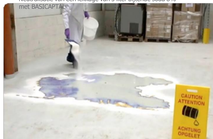
Neutralisatie van een lekkage van 5 liter bijtende soda 8% met BASICAPTAL®
